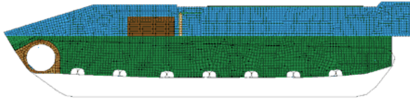
Rys. 7. Model numeryczny pojazdu KRAB – widok lewej burty
