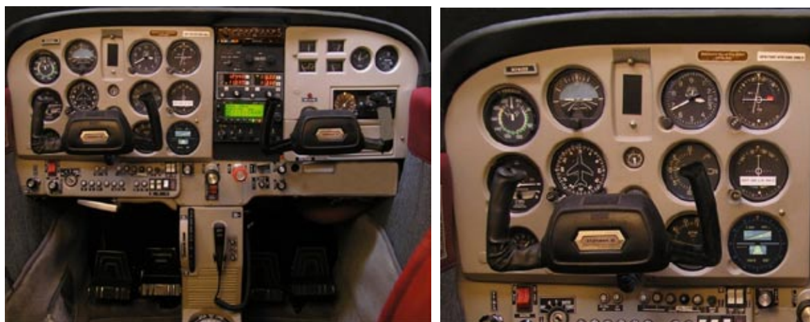
Rys. 3. Instalacja wskaźników CDI w symulatorze lotu
