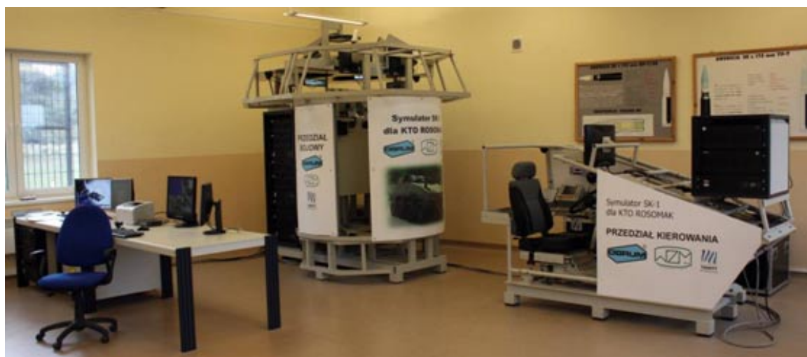
Rys. 1. Kompleksowy Symulator Strzelań dla załogi KTO Rosomak pierwszy egzemplarz, użytkowany aktualnie przez CSWL Poznań
