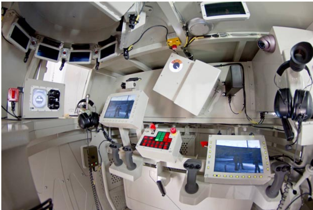
Rys. 4. Wnętrze modułu SKMB, stanowisko działonowego i dowódcy KTO
