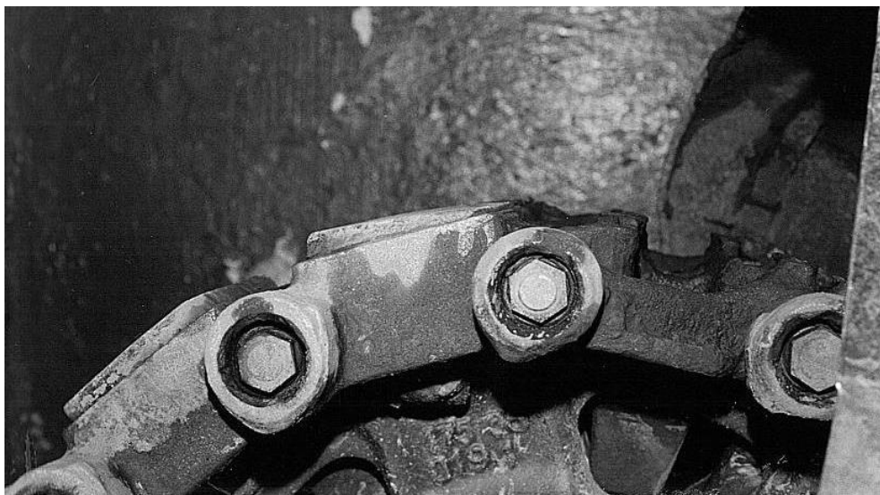
Rys. 8. Charakterystyczne zużycie nakładki A od strony ogniwa bez nakładki [12]
