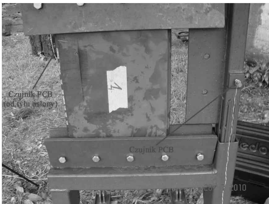
Rys. 4. Zamocowanie próbki i czujników przyspieszeń M350B21
