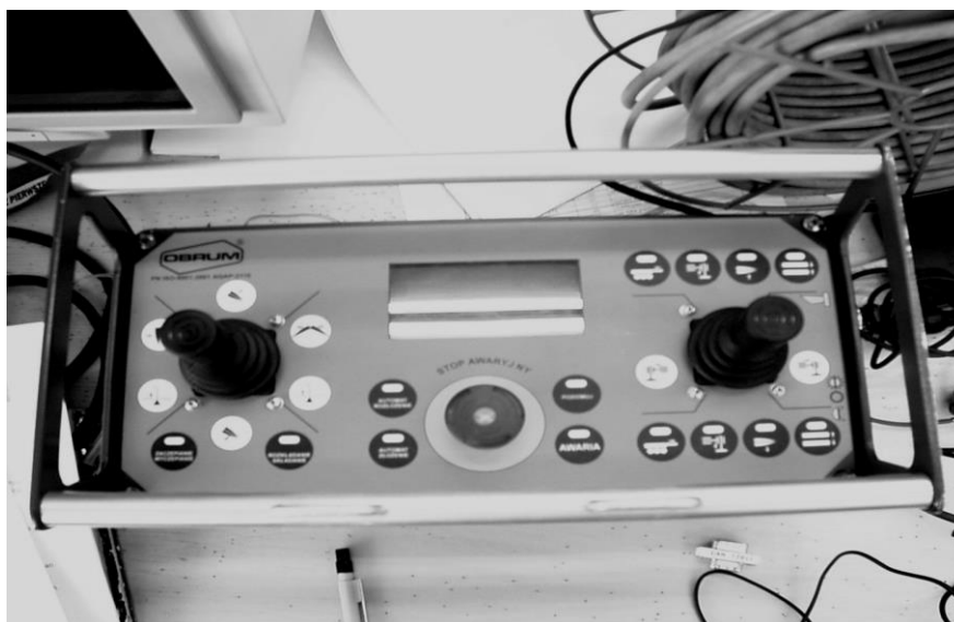
Rys. 2. Panel sterujący maszyny inżynieryjno-drogowej MID
