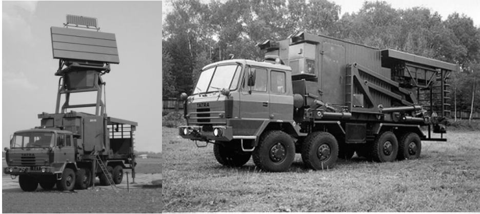
Rys. 1. Mobilna stacja radiolokacyjna JBR-15 na podwoziu TATRY [4], [5]
