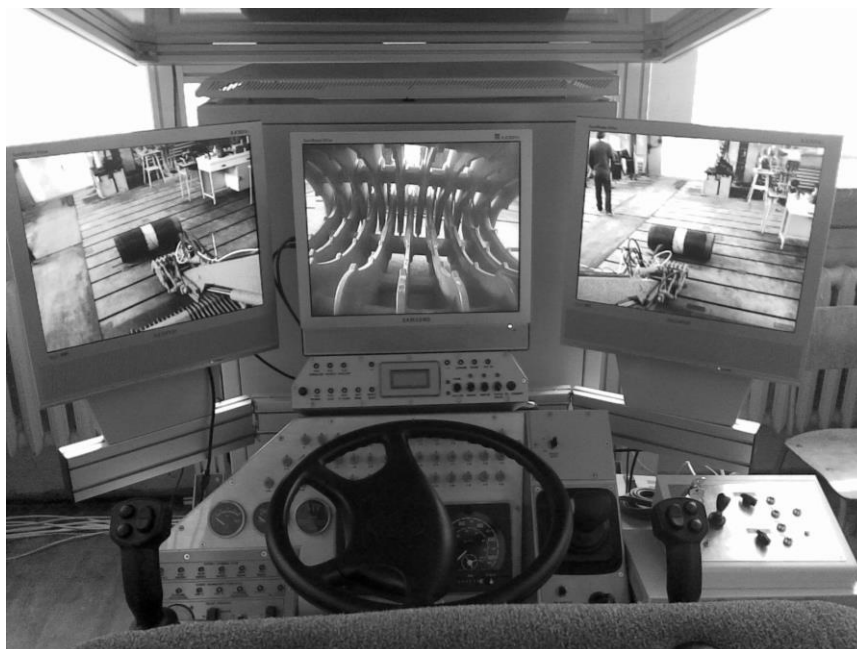
Rys. 4. Stanowisko operatora do testowania systemu zdalnego sterowania osprzętem roboczym opartego na magistrali CAN
