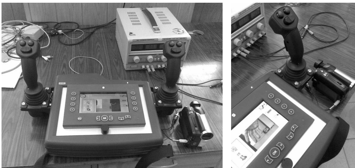
Rys. 5. Pulpit sterujący pojazdu bezzałogowego wraz z kamerą
