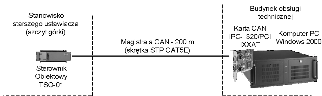
Rys. 1. Połączenie sterownika głównego ze sterownikiem obiektowym
