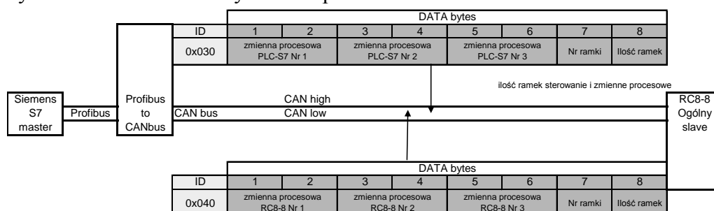
Rys. 4. Wymiana danych w warstwie zmiennych procesowych
