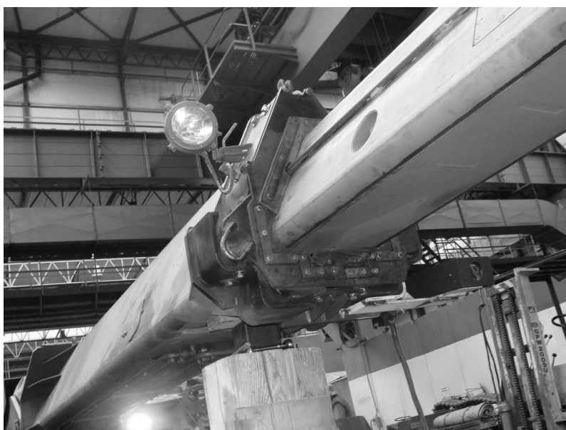
Rys.4. Montaż kamery szerokokątnej wraz z reflektorem na członie stałym wysięgnika
