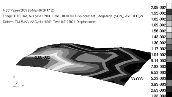
Rys. 20. Charakter deformacji płyty uderzanej
