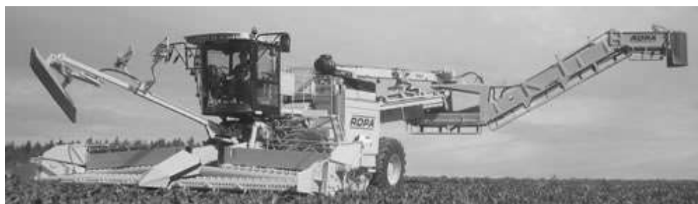
Rys.1. Doczyszczarko-ładowarka ROPA Euro-MAUS 3
