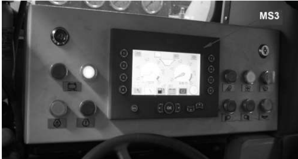
Rys. 2. Moduł MS3 – pulpit sterujący ładowarki LKP-0903 wraz z panelem LCD
