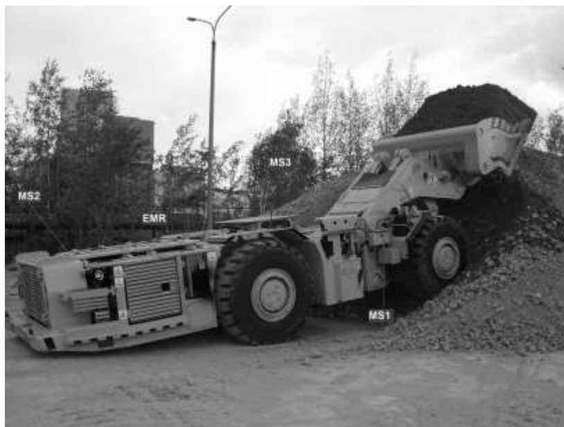
Rys. 1. Modułowa struktura układu mechatronicznego ładowarki LKP-0903
