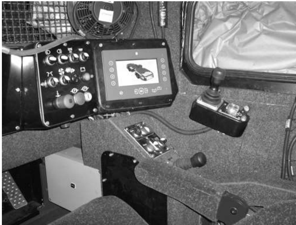
Rys. 5. Przykład aplikacji - specjalizowana maszyna kopalniana - wnętrze kabiny z wyświetlaczem DP 600. Magistrala CAN zrealizowana w oparciu o światłowody
