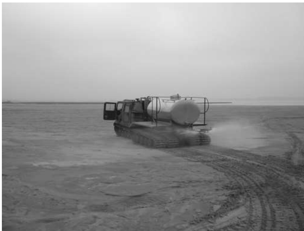
Rys. 6. Przykład aplikacji specjalizowana maszyna do oprysków zbiornika odpadów poflotacyjnych. System Plus+1 odpowiada za hydrostatyczny napęd jazdy i sterowanie układem roboczym
