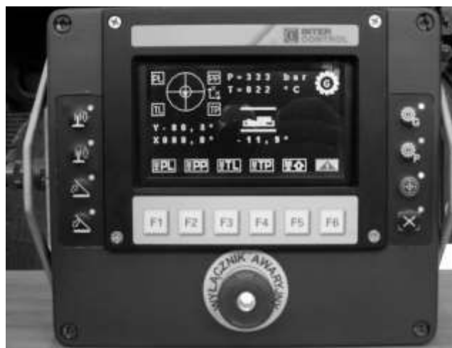
Rys. 3. Wyośny pulpit sterowania konstrukcji OBRUM sp. z o.o. – Gliwice oparty na wysokiej klasy wyświetlaczu LCD firmy InterControl.
