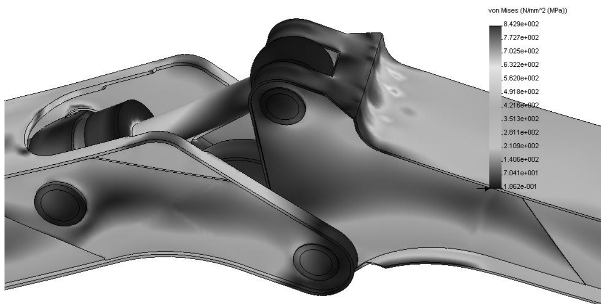
Rys. 5. Rozkład pola naprężeń dla podpory- fragment konstrukcji
