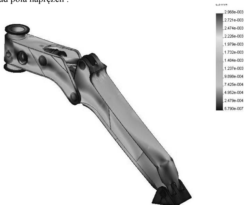
Rys. 3 Odkształcenia konstrukcji dla obciążenia w [m]. Deformacja w skali 7:1
