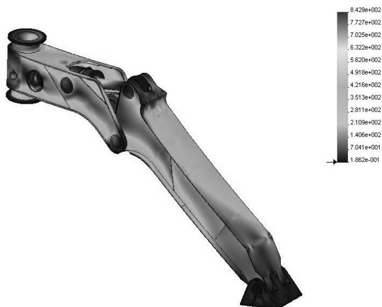
Rys. 4. Rozkład pola naprężeń zredukowanych w modelu podpory w [MPa]-widok z góry
