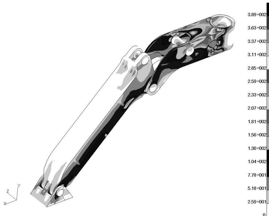
Rys. 10. Rozkład naprężeń zredukowanych w [MPa]
