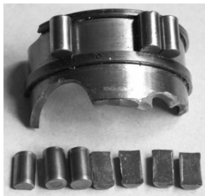
Rys. 2. Obraz zniszczonego łożyska walczkowego ustalającego koło obiegowe w przekładni planetarnej
