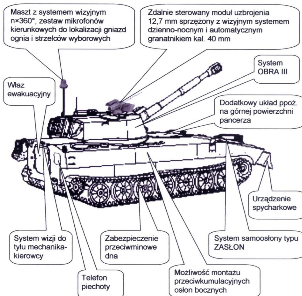
Rys. 5. Czołg do walki w terenie zurbanizowanym i górskim na bazie armato-haubicy Goździk - koncepcja
