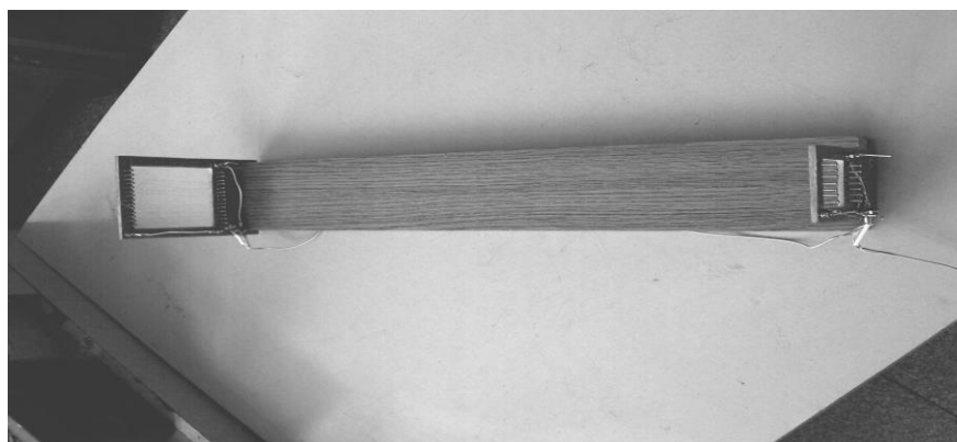
Rys. 9. Widok przyrządu do pomiaru prędkości wylotowej pocisku
