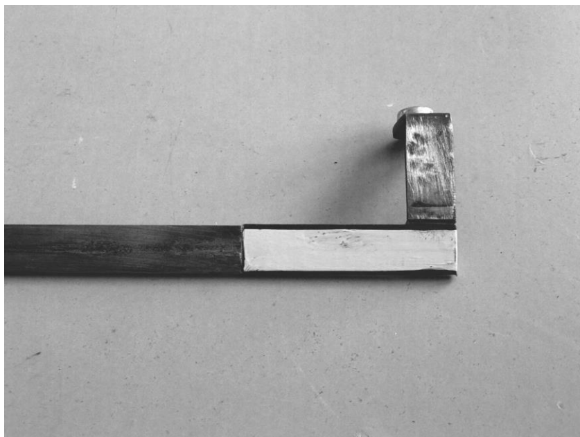
Rys. 7. Widok szyny miedzianej z zaizolowanym rozbiegiem
