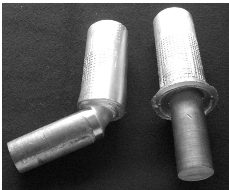
Rys. 5. Próbkki po zgrzewaniu tarcowym [11]
