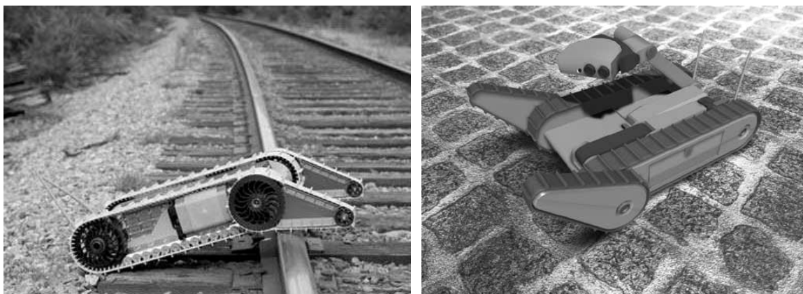
Rys. 12. Robot PackBot wykorzystywany w Iraku i Afganistanie, oraz jego następcą SUGV
