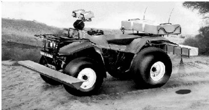
Rys. 13. Koncepcja robota do testów z wykrywaniem min
