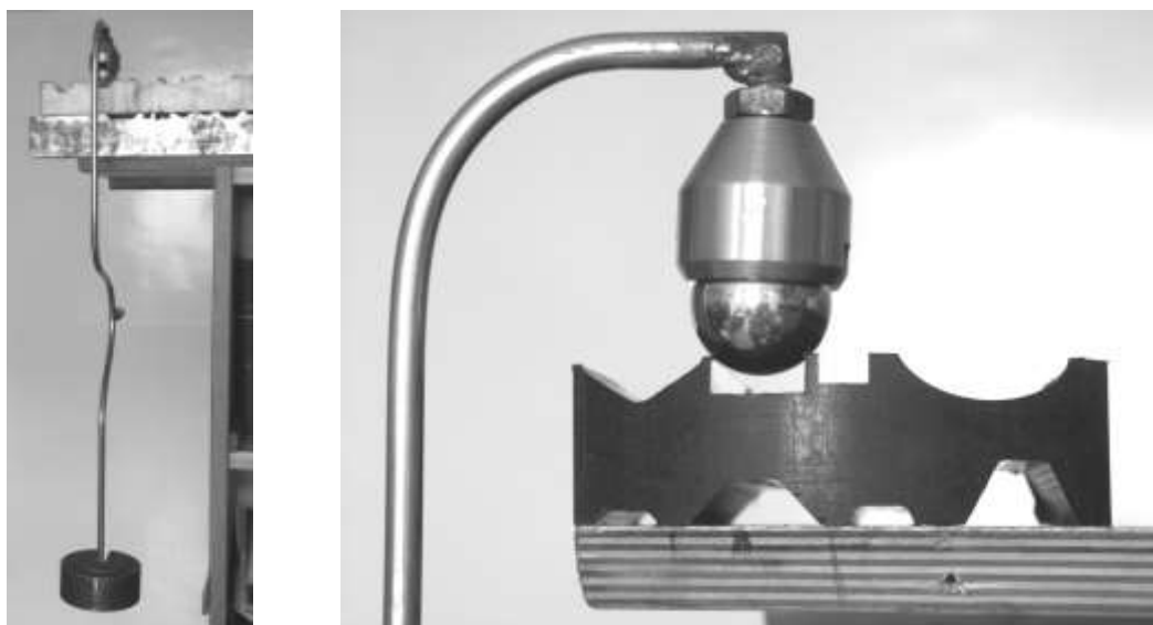
Rys. 2. Stanowisko do porównywania oporów ruchu tocznego
