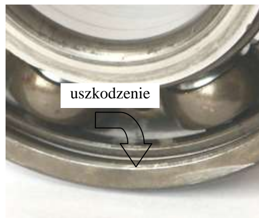
Rys. 8. Uszkodzenie bieżni zewnętrznej łożyska tocznego
