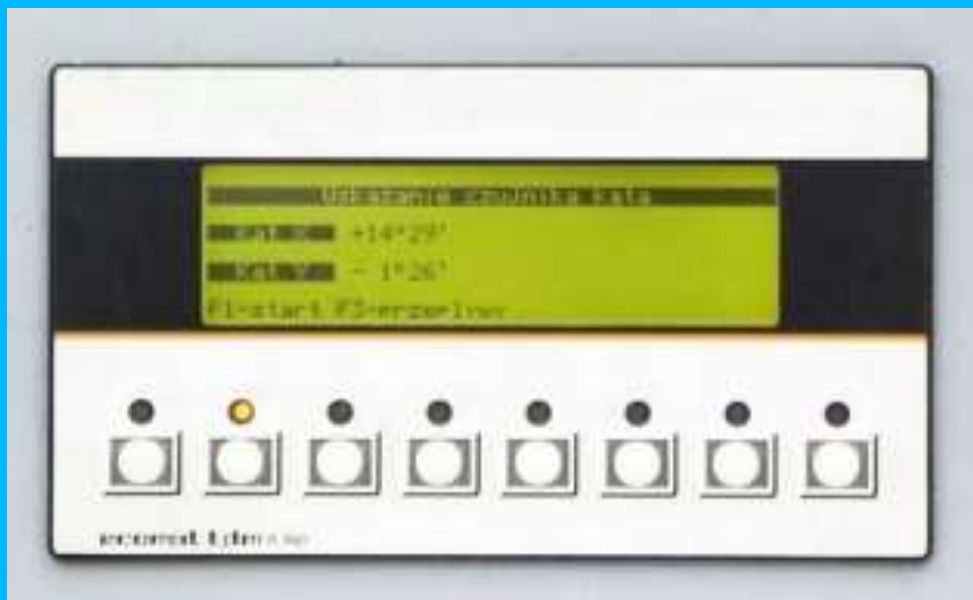
Rys.7. Ekspozycja pomiaru kąta na wyświetlaczu
