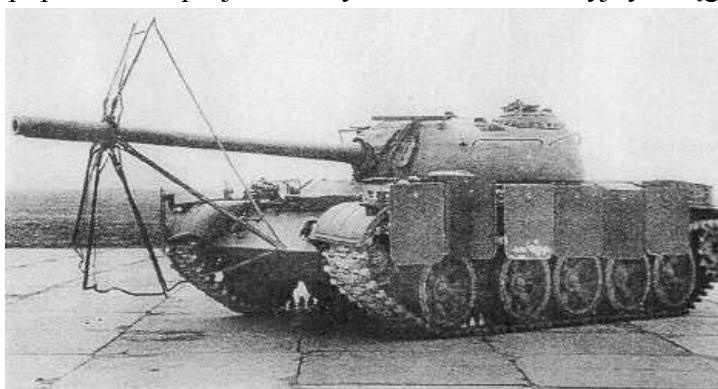
Rys. 1. Ciekawe rozwiązanie ekranów przeciwkumulacyjnych czołgu T-55. Zwracają uwagę: "parasol" na lufie i pionowe płyty osłaniające układ jezdny ustawione pod kątem do kierunku jazdy. (TDW)
