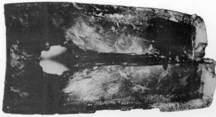
Rys. 6. Zniszczona okładzina płytki ERA. (TDW)
