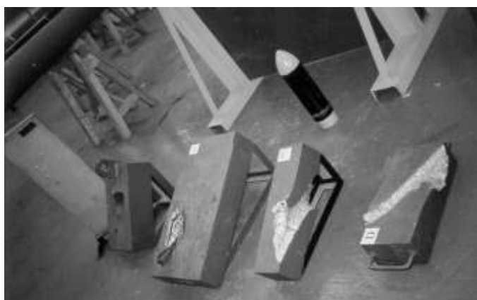
Rys. 7. Płyty pancerne przebite pociskami podkalibrowymi. (fot. C. Galiński)
