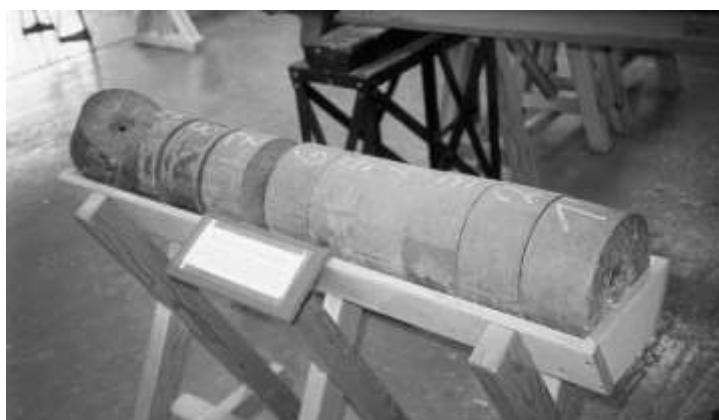
Rys. 3. Krater utworzony przez strumień kumulacyjny w bloku stalowym. (fot. C. Galiński)
