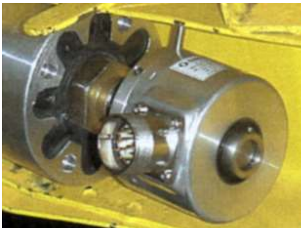
Rys. 2. Przetwornik obrotowo-impulsowy GI 331 mocowany na osi koła jezdnego wózka.
