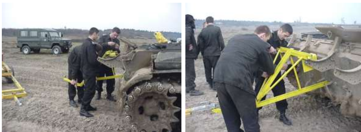
Rys. 4. Montaż elementu konstrukcyjnego (haka) zapewniającego podczepienie wózka do czołgu T-55 A
