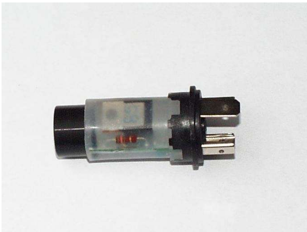
Rys. 1. Sygnalizator poziomu cieczy SPO-11S – zespół elektroniczny zalany hermetycznie kauczukiem silikonowym
