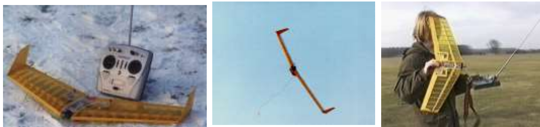
Rys. 9 Polski MBSL „Pszczoła” o rozpiętości 0,635m i masie 170g
