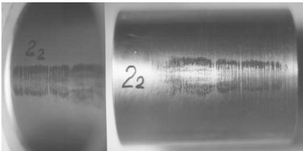
Rys. 1. Wyniki obciążania połączenia sworzniowego siłą zmienną F_r = 100/10 kN [4]
