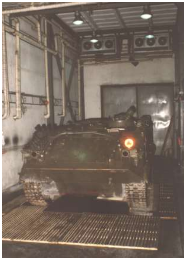
Rys. 2. Maszyna inżynieryjno-drogowa BIZON-S z zainstalowanymi czujnikami pomiarowymi.
