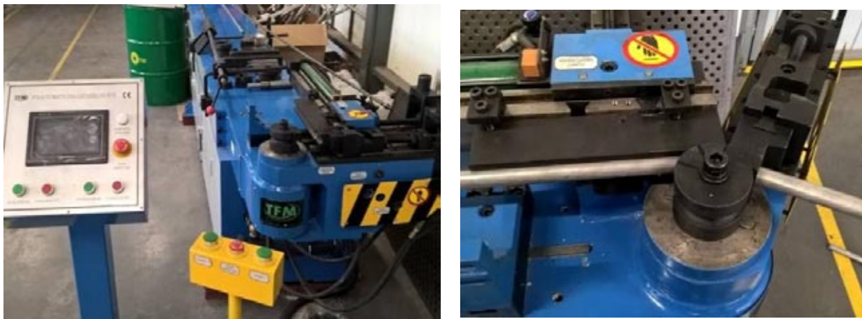
Rys. 5. Giętarka GM-38NCB z oprzyrządowaniem do gięcia rur ze stopów magnezu
