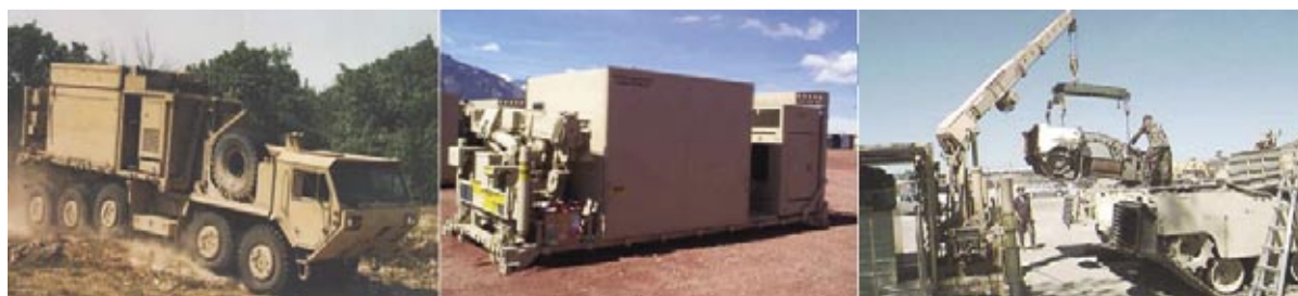
Rys. 2. Forward Repair System na pojeździe typu HEMTT podczas transportu (z lewej), stanowisko pracy po rozładunku z pojazdu transportującego (w środku) i podczas prac remontowych (z prawej) [5]
