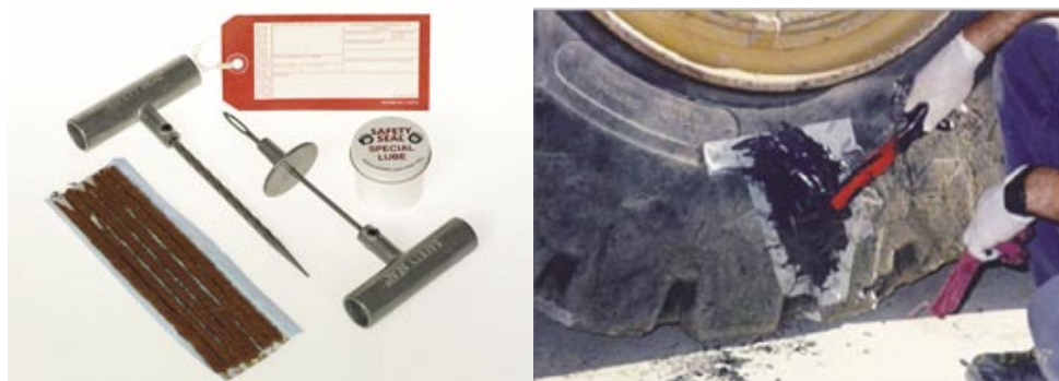
Rys. 8. Metody naprawy opon z użyciem specjalnego zestawu (z lewej) i kompozytów klejowych (z prawej)
