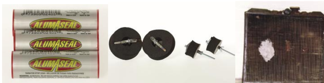
Rys. 9. Metody naprawy małych otworów za pomocą szczeliwa (z lewej) oraz dużych otworów za pomocą korków (pośrodku) i kompozytu klejowego (z prawej)
