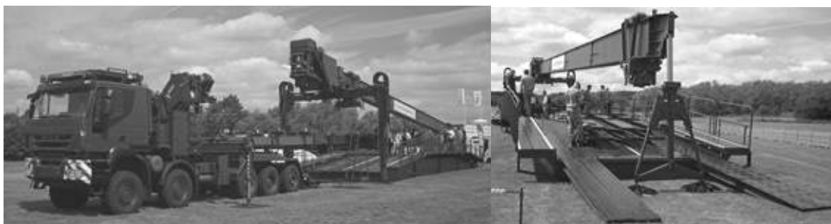
Rys. 6. Przęsło „szwajcarskiej” wersji mostu DSB z chodnikami i poręczami z pojazdem układającym na podwoziu IVECO Trakker 10×8
