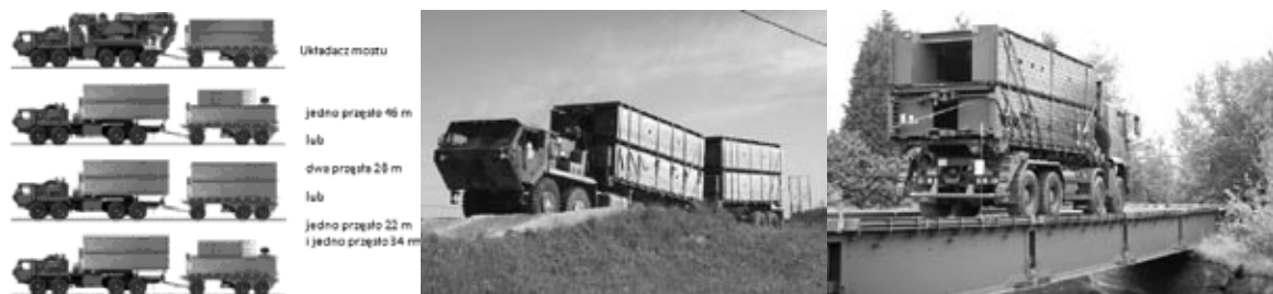
Rys. 4. Schemat kompletu mostu M18 DSB, pojazd transportowy CBT Oshkosh M1077 z przyczepą M1076 oraz pojazd transportowy IVECO 8×8 [16]
