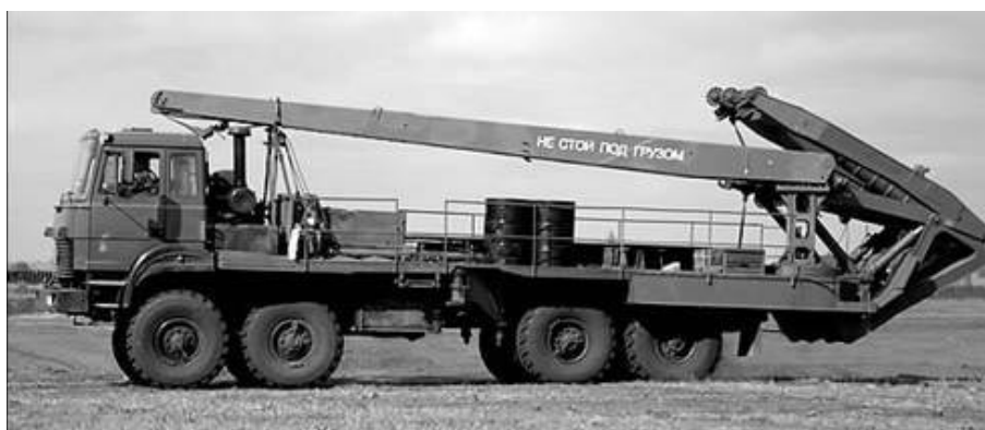
Rys. 10. Pojazd układacz (MCM) z zestawu mosty MMK [21]
