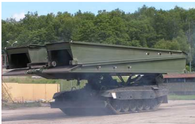
Rys. 10. Most szturmowy PMC - LEGUAN (podwozie PT-91M o sześciu parach kół nośnych)
