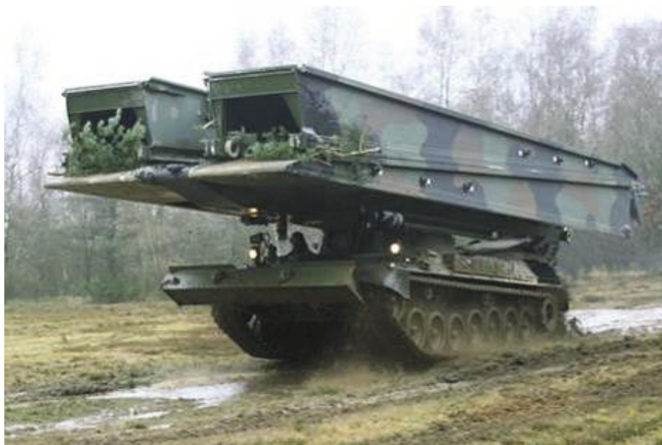
Rys. 2. Most KMW LEGUAN (podwozie LEOPARD 1 o siedmiu parach kół nośnych)
