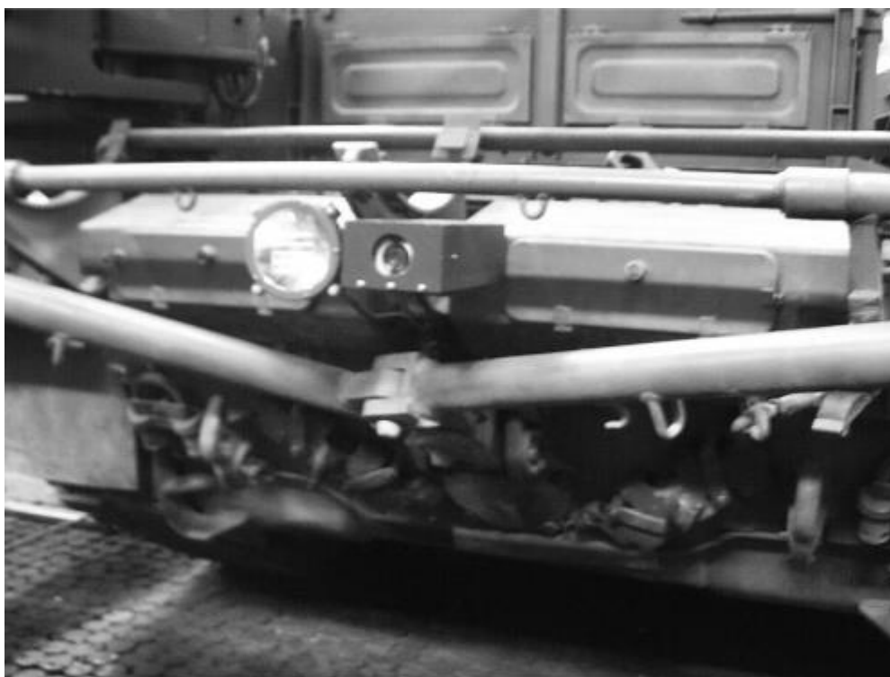
Rys. 3. Zabudowa kamery w tylnej części korpusu MID
