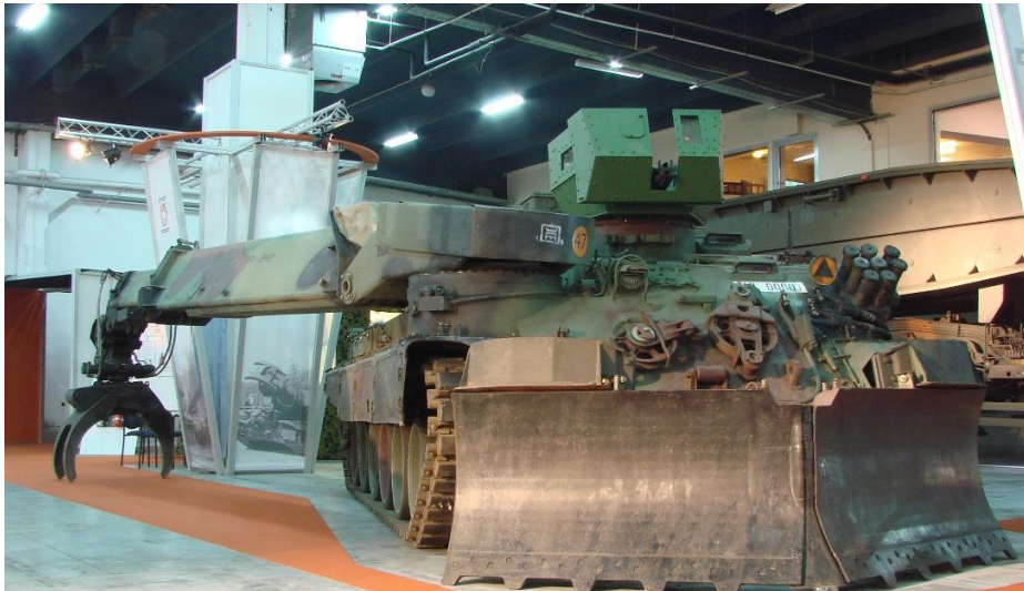
Rys. 2. Maszyna inżynieryjno-drogowa MID - M
