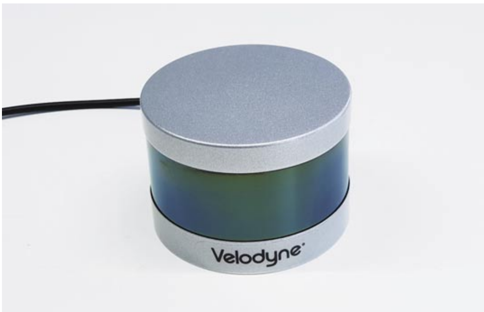
Rys. 3. LiDAR 3D firmy Velodyne (fot. OBRUM sp. z o.o.)
