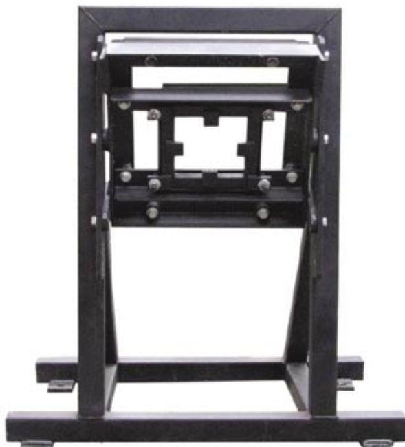
Rys.4. Stanowisko do badania pojedynczych próbek opancerzenia dodatkowego
