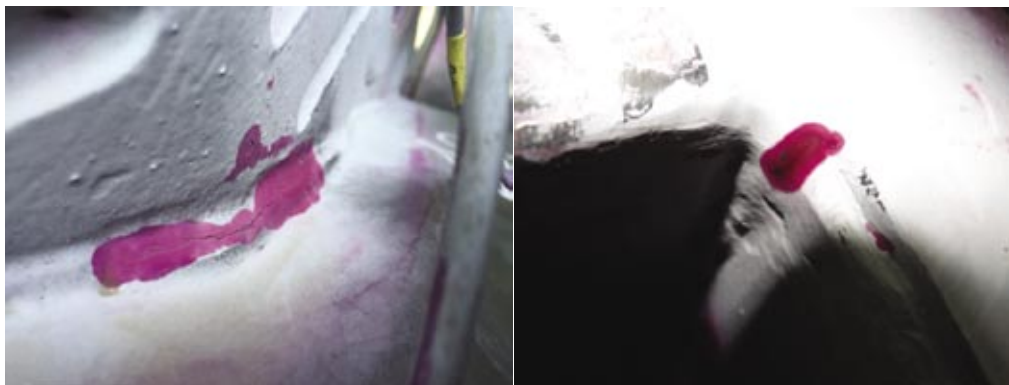
Rys. 6. Przykłady wyników badań spoin metodą PT – widoczne niezgodności spawalnicze w postaci pęknięć
