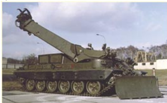
Rys. 3. Tuba wysuwna żurawia maszyny inżynieryjno-drogowej MID
