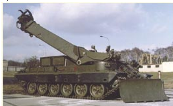
Rys. 3. Tuba wysuwna żurawia maszyny inżynieryjno-drogowej MID
