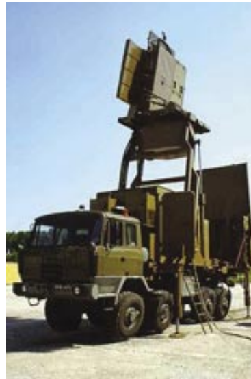
Rys. 1. Fragment ramowego układu wsporczy stacji radiolokacyjnej JBR-15
