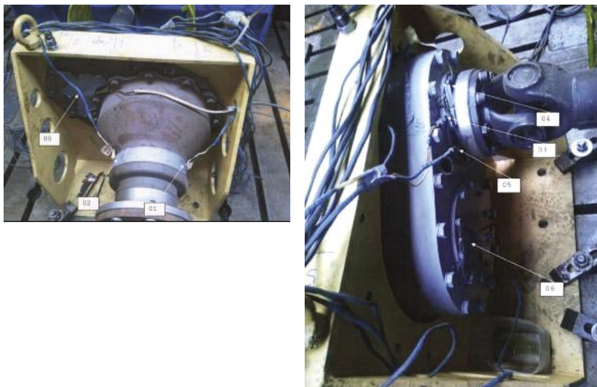
Rys. 3. Rozmieszczenie punktów pomiaru temperatury
