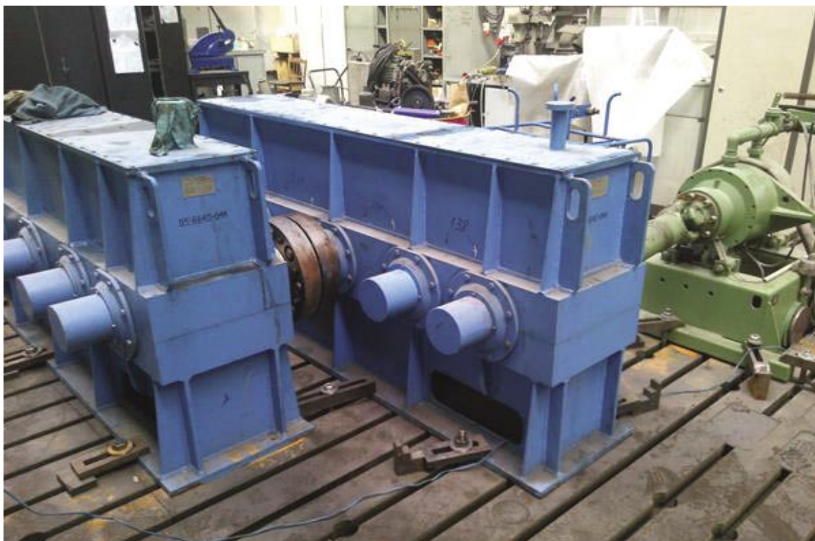
Rys. 2. Fragment stanowiska do badania pod obciążeniem roboczym
