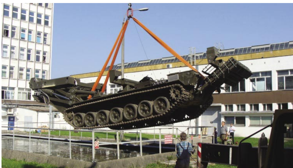
Rys. 4. Badanie siły wyporu podwozia [2]
