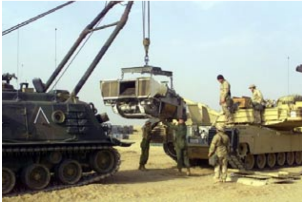
Rys. 1. Wymiana jednostki napędowej w pojeździe ABRAMS
