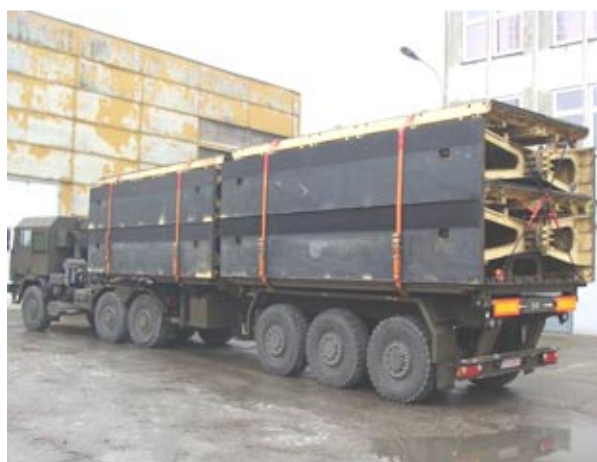
Rys. 10. Widok pojazdu transportowego z przęsłami głównymi mostu MS-40
