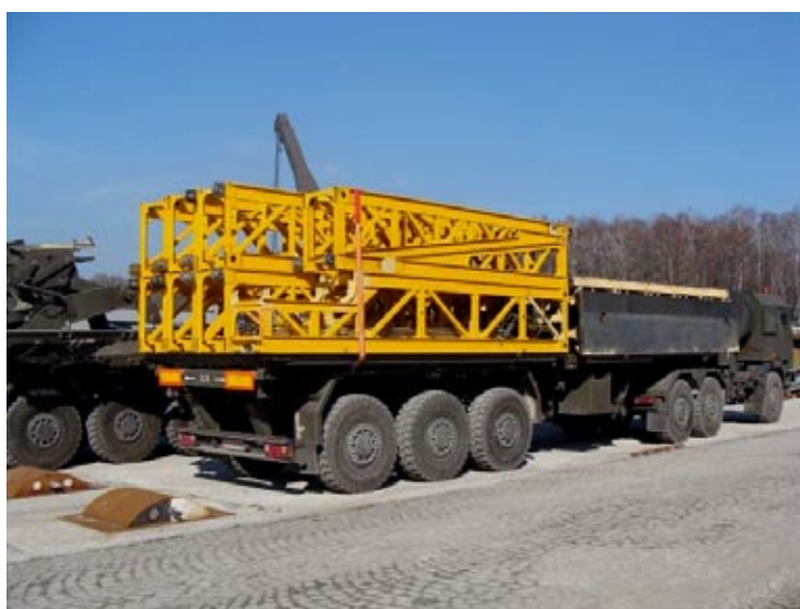
Rys. 11. Przęsła pomocnicze mostu MS-40 na pojeździe transportowym
