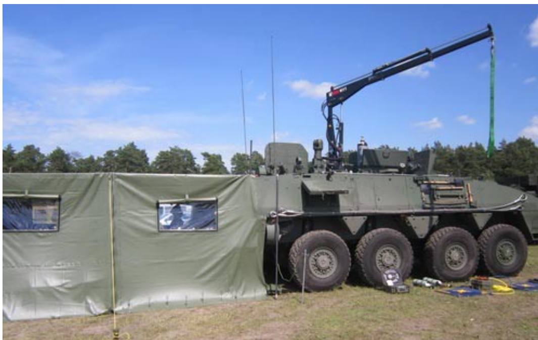
Rys. 7. KTO Rosomak w wersji WRT (Wóz Rozpoznania Technicznego) [4]
