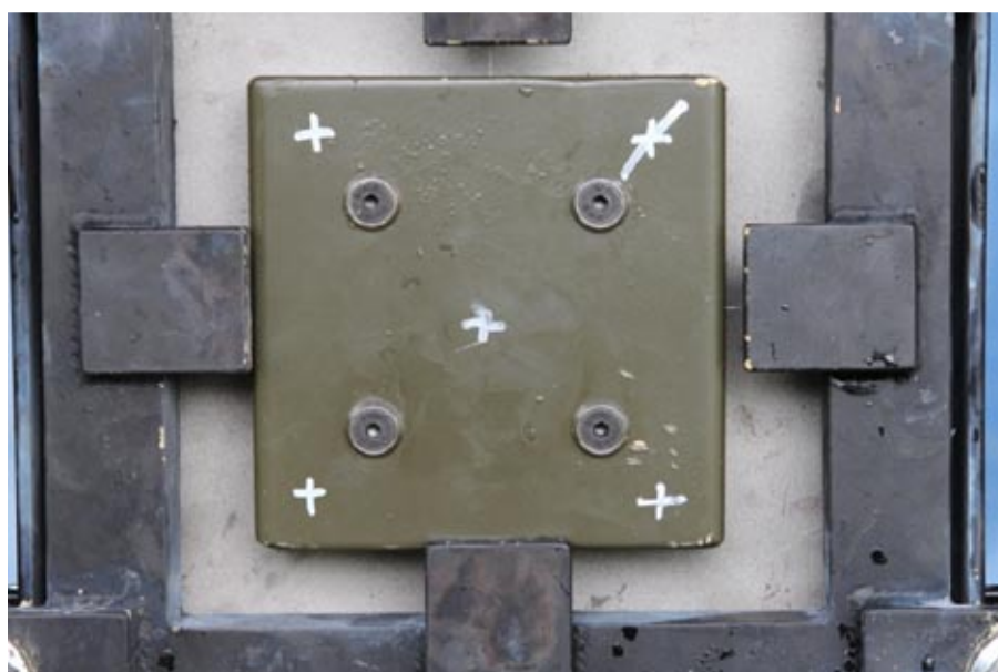
Rys. 4. Próbką pancerza zamontowana na stanowisku badawczym
