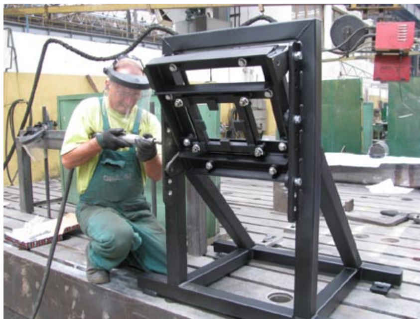
Rys. 3. Stanowisko do prób ostrzałem – prace montażowe
