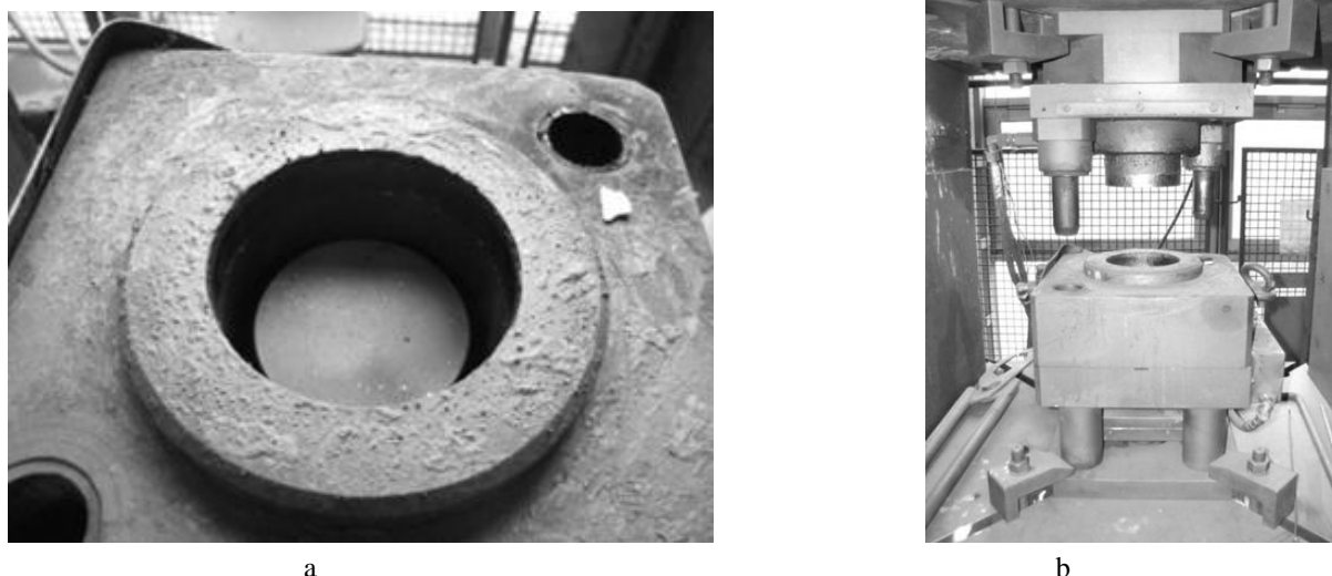
Rys. 5. Forma i stanowisko do odlewania kompozytów metalowych na zmodernizowanej prasie PHM-160
