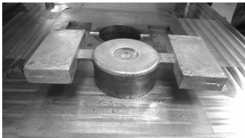
Rys. 10. Widok podwójnego odlewu podstawowego elementu pancerza (PEP) wraz z układem wlewowym, bezpośrednio po wyjęciu z formy (w tle widoczna jej dolna połowa)
