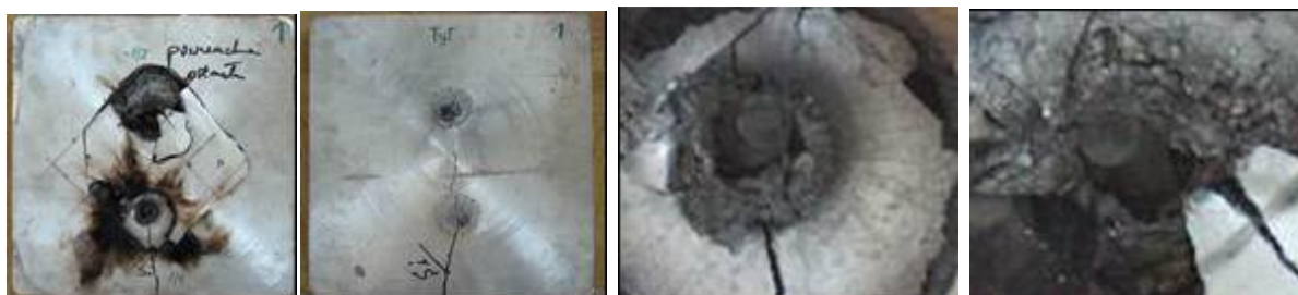
Rys. 3. Widok przodu i tyłu panelu nr 8 po uderzeniu dwoma pociskami oraz widok części pocisku tkwiącej w panelu
