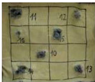
Rys. 4. Panel pancerza z ceramiką B_4C (grubość - 20 mm, masa - 32 \text{ kg/m}^2 ) przód i tył
