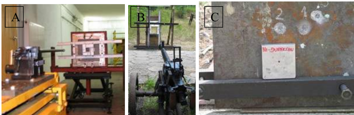
Rys. 2. Widok stanowiska badawczego w WITU dla ostrzału pociskami kalibru 7,62 mm (A) i 12,7 mm (B) oraz panel odlewany przed ostrzelaniem, umieszczonych na płycie RHA (C)
