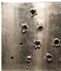
Rys. 6. Panel pancerza z ceramiką B_4C (grubość - 15 mm, masa - 26 \text{ kg/m}^2 ) przód i tył
