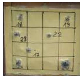
Rys. 5. Panel pancerza z ceramiką SiC (grubość - 20 mm, masa - 38 \text{ kg/m}^2 ) przód i tył
