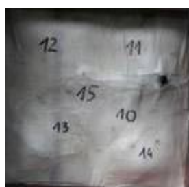
Rys. 4. Panel pancerza z ceramiką B_4C (grubość - 20 mm, masa - 32 \text{ kg/m}^2 ) przód i tył
