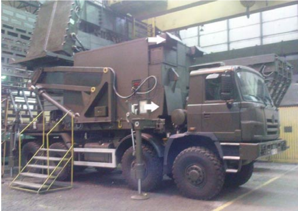
Rys. 1. Stacja radiolokacyjna JBR-15M z zaznaczonymi wlotami układu wentylacji
